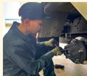
車両後輪の点検整備
